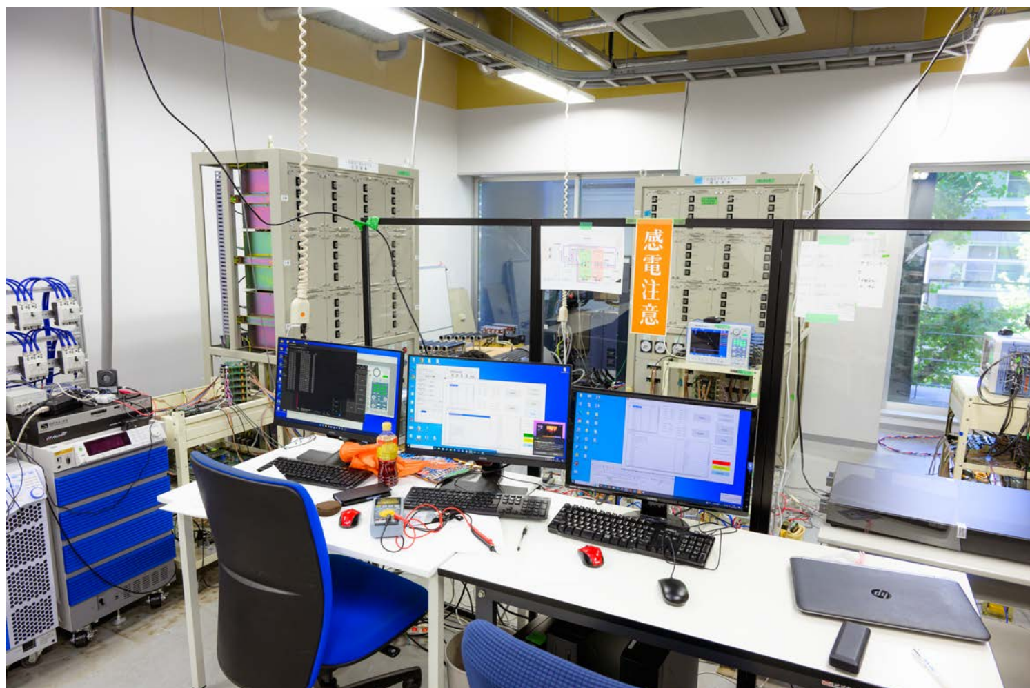
交流系統を模したリアルタイムシミュレータとシミュレーションを行うコンピュータ
