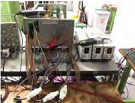
インダクタの小型・軽量化が実現可能な補助変換器を用いた双方向チョッパの外観図
